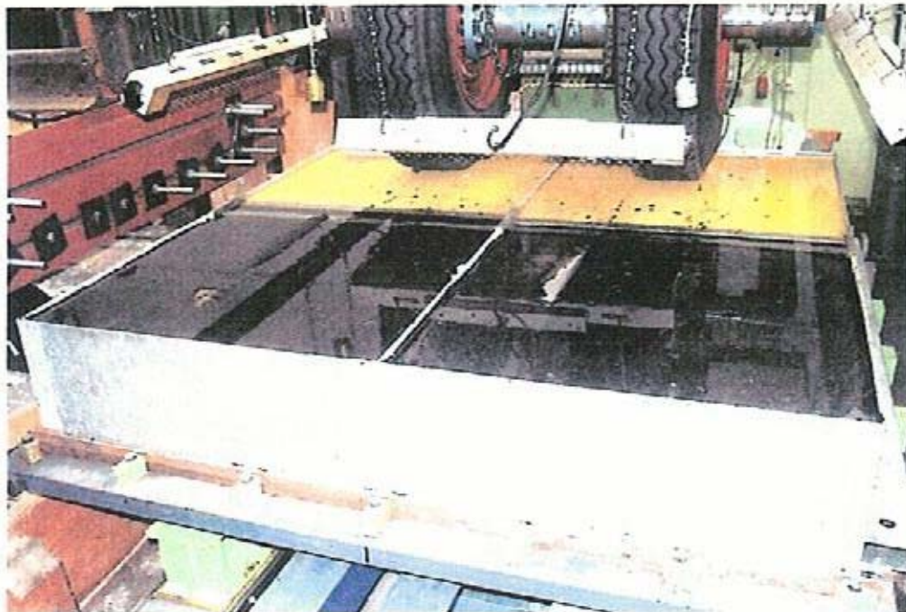
Bild 7: Messung der Längsprofil-Geometrie
