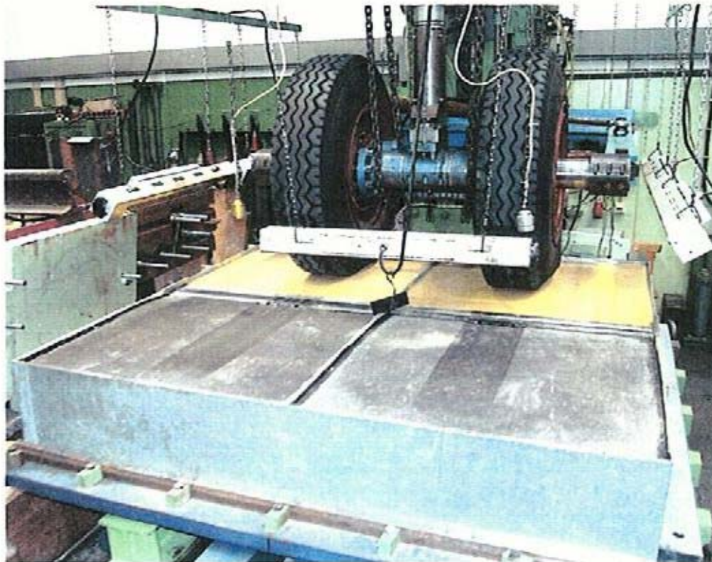
Bild 1: Prüfkörper mit Gußasphalt (Vordergrund) und Beton mit Kunstharzbeschichtung (Hintergrund) nach 4400 Lastwechsel (Versuchsphase I)
