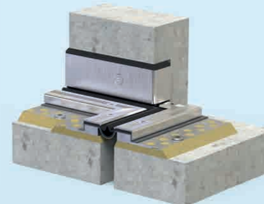
BUCHBERGER PROFILSYSTEME VA.8.95/.. Eck-Stück waagrecht mit Übergang Boden-Boden zu Boden-Wandausführung W3 und End-Stück h = 50 mm
